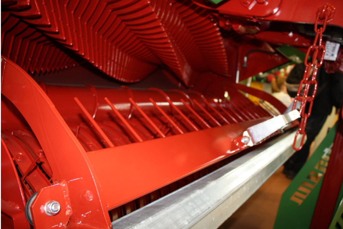
STRAUTMANN GIGA VITESSE CFS vals fördelar grödan jämn och tillför materialet över hela rotorbredden till snittapparat
