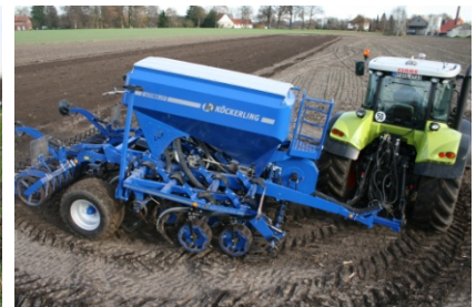
ULTIMA CS arbetsbredd 4,00 m, transportbredd 3,00 m, 22 såelement, radavstånd 185 mm, Radbredd 60 mm, tankvolym 2800 liter, dragkraftsbehov 180 hk
