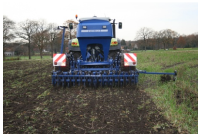
ULTIMA CS arbetsbredd 4,00 m, transportbredd 3,00 m, 22 såelement, radavstånd 185 mm, Radbredd 60 mm, tankvolym 2800 liter, dragkraftsbehov 180 hk
