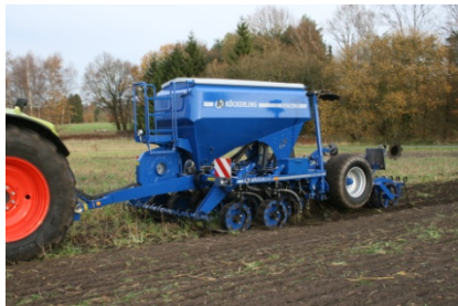
ULTIMA CS arbetsbredd 4,00 m, transportbredd 3,00 m, 22 såelement, radavstånd 185 mm, Radbredd 60 mm, tankvolym 2800 liter, dragkraftsbehov 180 hk
