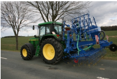
Den massiva crossboarden sørjer för en utjämning också av större jordinslag och fungerar även för nysådd i plogtiltor och en jämn såbädd. Arbetsbredd 3 m / 6 m, transportbredden 3,0 m, 120 / 240 8 mm pinnar. En pneumatisk tillsatssåmaskin levereras som tillval.
