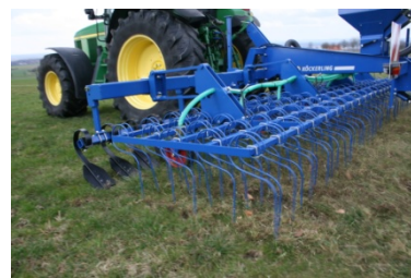
Den massiva crossboarden sørjer för en utjämning också av större jordinslag och fungerar även för nysådd i plogtiltor och en jämn såbädd. Arbetsbredd 3 m / 6 m, transportbredden 3,0 m, 120 / 240 8 mm pinnar. En pneumatisk tillsatssåmaskin levereras som tillval.
