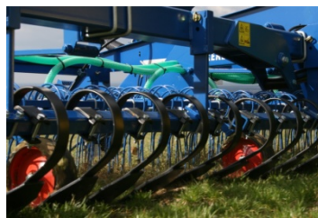
Den massiva crossboarden sørjer för en utjämning också av större jordinslag och fungerar även för nysådd i plogtiltor och en jämn såbädd. Arbetsbredd 3 m / 6 m, transportbredden 3,0 m, 120 / 240 8 mm pinnar. En pneumatisk tillsatssåmaskin levereras som tillval.
