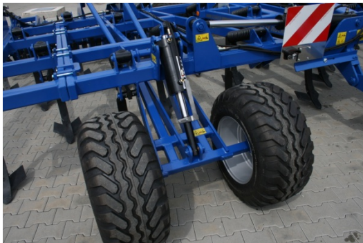
KÖCKERLING VECTOR med unik EASY-SHIFT djupinställning som ger föraren möjlighet att ställa in djupet parallellt under körning, utan att traktorföraren behöver stanna eller kliva av traktorn.
