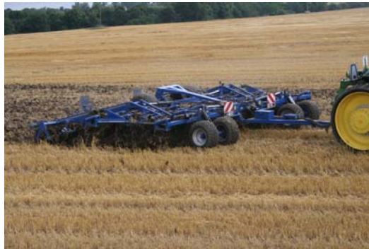
KÖCKERLING VECTOR med unik EASY-SHIFT djupinställning som ger föraren möjlighet att ställa in djupet parallellt under körning, utan att traktorföraren behöver stanna eller kliva av traktorn.
